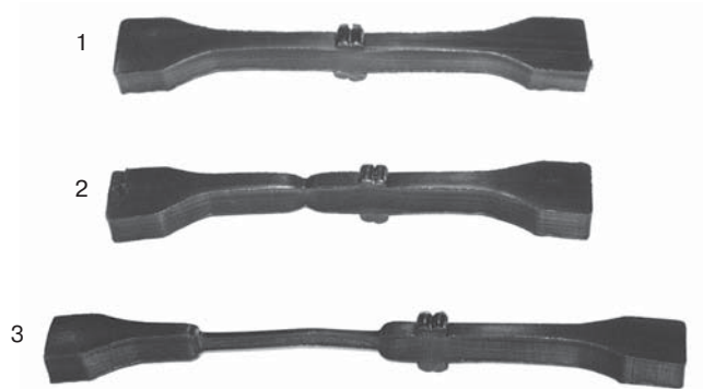
Фото 4.2.9. Образец с фрагментом стыкового сварного соединения (1).
