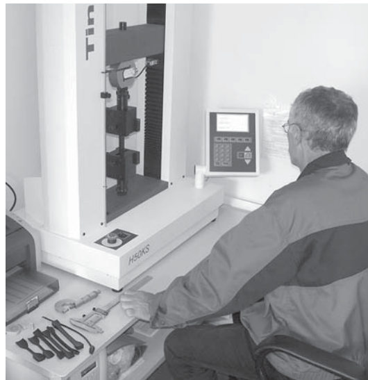
Фото 4.2.8. Испытания стыковых сварных соединений в лаборатории ИКАПЛАСТ
